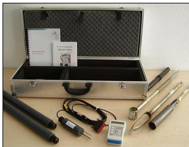
Рис. 1. Комплект для экспресс-анализа влажности почв: ручной прибор-индикатор HH2 Moisture Meter, Гидрозонд FDR ML2x «Эко-Тех», Германия
